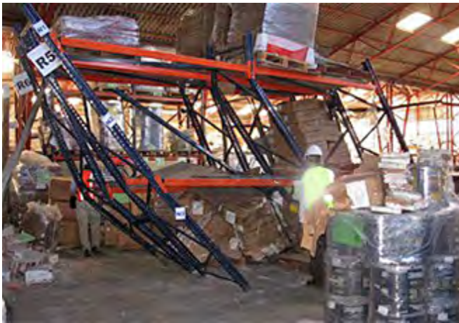
Fig. 2.23.6 et 2.23.7 > Défaillance dans le plan («in-plane») suite à un assemblage et à un ancrage insuffisants
