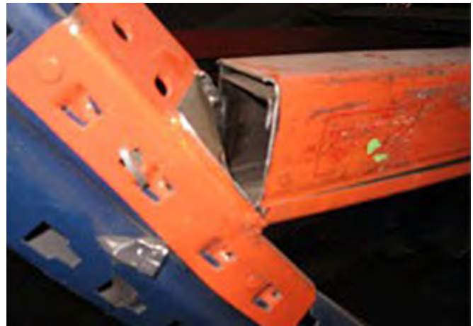
Fig. 2.23.6 et 2.23.7 > Défaillance dans le plan («in-plane») suite à un assemblage et à un ancrage insuffisants
