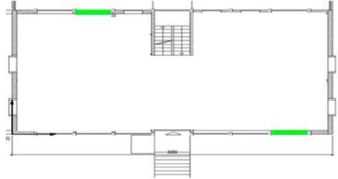
Vue en plan avec les deux nouvelles parois en béton armé (en vert) intégrées dans les façades longitudinales.
