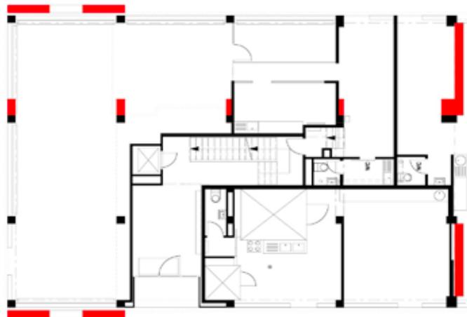
Vue en plan du rez-de-chaussée, avec les nouvelles parois en béton armé (Lateltin, 2003).
