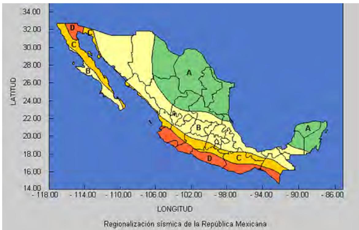
Figura 2-10 - Zonificación sísmica de México (Manual de Diseño de Obras Civiles [Diseño por Sismo] de la Comisión Federal de Electricidad - <https://www.sgm.gob.mx/Web/MuseoVirtual/Riesgos-geologicos/Sismologia-> de Ciudad de México.html - última visita 25/01/2018).
