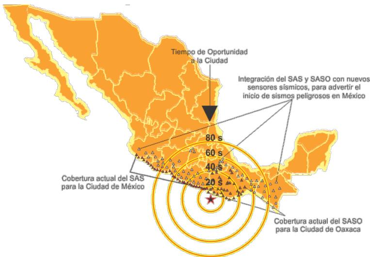
Figura 2-7 - Sistema de Alerta Sísmica Mexicana. Los triángulos representan las estaciones de la red de alerta y los círculos concéntricos el tiempo de propagación de las ondas desde el epicentro (triángulo rojo).
