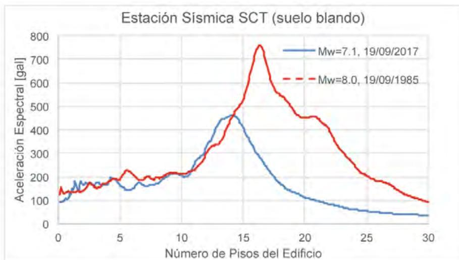
Figura 6 30 – Aceleración espectral seguida por el número de niveles por 1985 (rojo) y 2017 (azul) sobre un suelo blando ( UNAM 23.09.2017)
