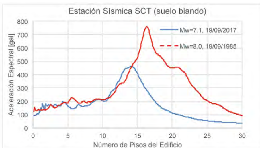
Figure 6 30 - Accélération spectrale suivant le nombre d'étage pour 1985 (en rouge) et 2017 (en bleu) sur sol meuble (UNAM 23.09.2017)
