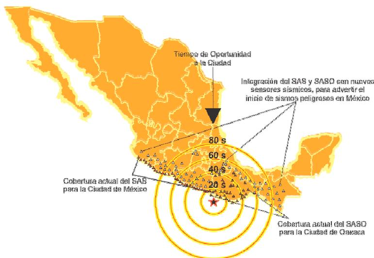
Figure 2-7 - Système d'alerte sismique du Mexique. Les triangles représentent les stations du réseau d'alerte et les cercles concentriques le temps de propagation des ondes depuis l'épicentre (triangle rouge).
